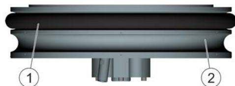
24. ábra: Az alsó tömítés felszerelése
