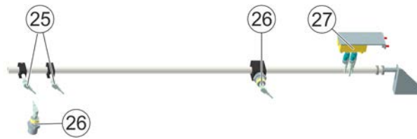
52. ábra: N03620063 felszerelhető iniciátor kapcsolózással, mechanikus
