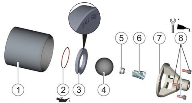
22. ábra: A dugattyúban lévő visszacsapó szelep összeszerelése
