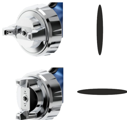
10. ábra: Levegősapka beigazítása
