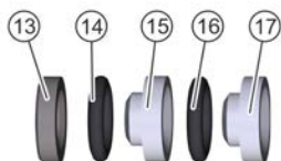
20. ábra: Vegye ki a tömítéseket
