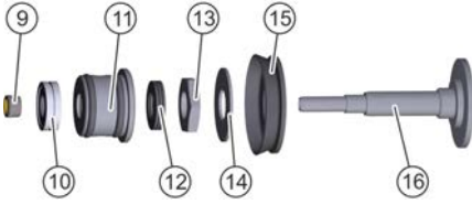
25. ábra: A dugattyútömitések cseréje
