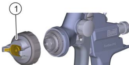
9. ábra: A levegőcsappantyú felhelyezése
