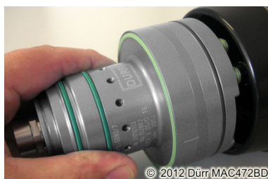
67. ábra: A turbina kivétele
