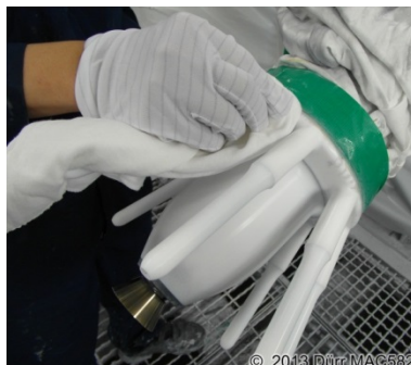
39. ábra: Az elektrodgyűrű tisztítása
