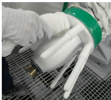
38. ábra: Az elektrodcsúcsok tisztítása
