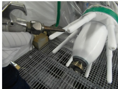
41. ábra: Az elektródhegyek és az elektródgyűrű tisztítása
