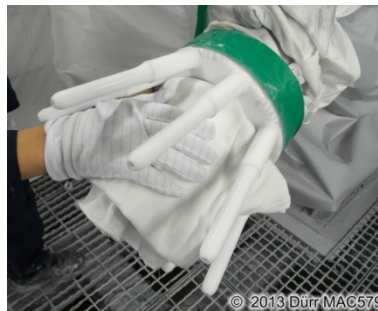
36. ábra: A porlasztóház tisztítása
