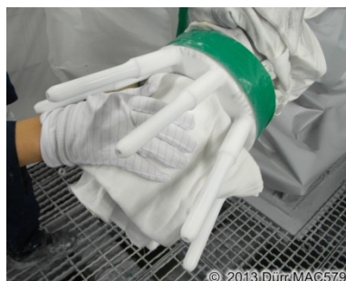
43. ábra: A teljes porlasztó szárítása
