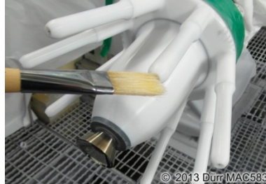
40. ábra: Az elektródhegyek tisztítása
