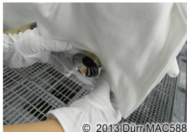
37. ábra: A tereleővegő-gyűrű tisztítása
