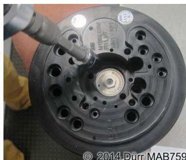
80. ábra: A főtűszelep kicsavarozása
