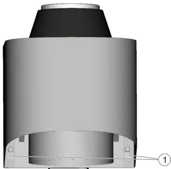
17. ábra: A fedőburkolat leszerelése
