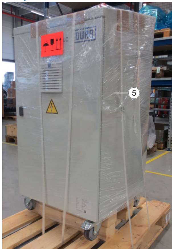
14. ábra: A Vezérlőszekrény fóliával körülcsavarva
