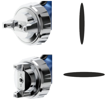
Fig. 10: Align air cap
